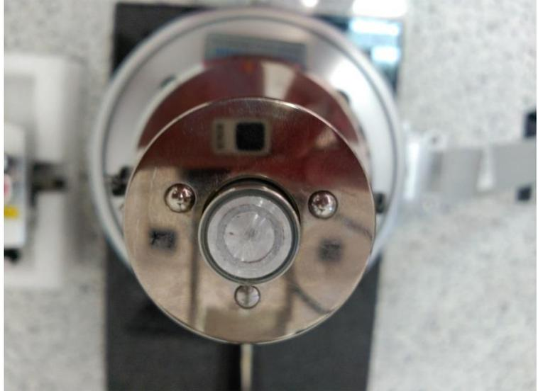
Colocar el cabezal y el holder con la punta y ajustar el láser para obtener máxima señal.
