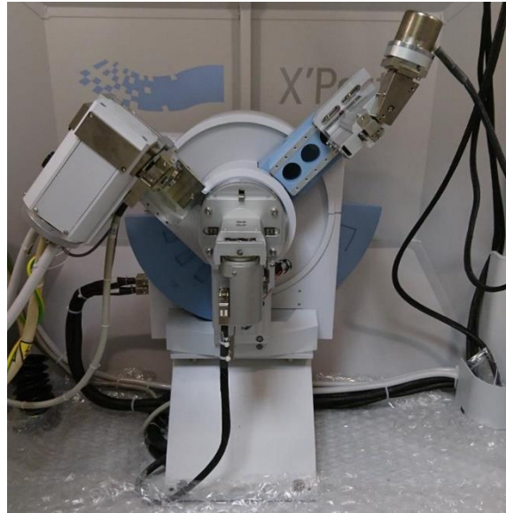
Figura 5-. Goniómetro durante una medida
