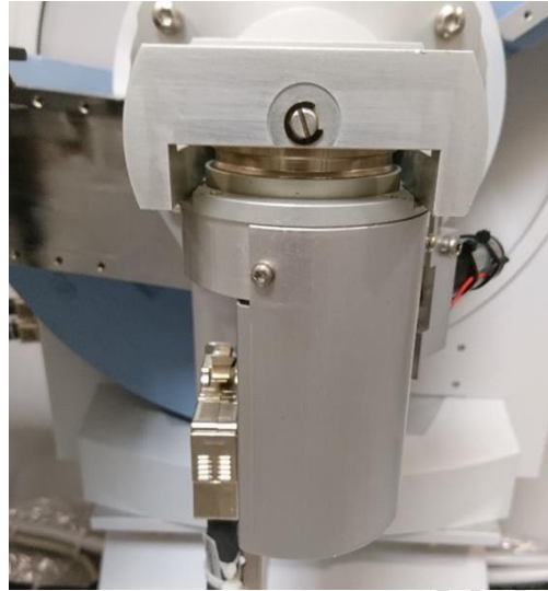
Figura 11-. Sistema portamuestras en ‘posición up’
