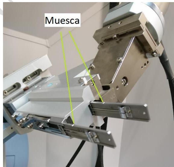
Figura 20-. Rendijas de antiscatter y recepción MAL colocadas
