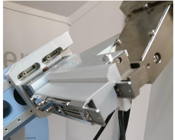
Figura 21-. Rendijas de antiscatter y recepción BIEN colocadas
