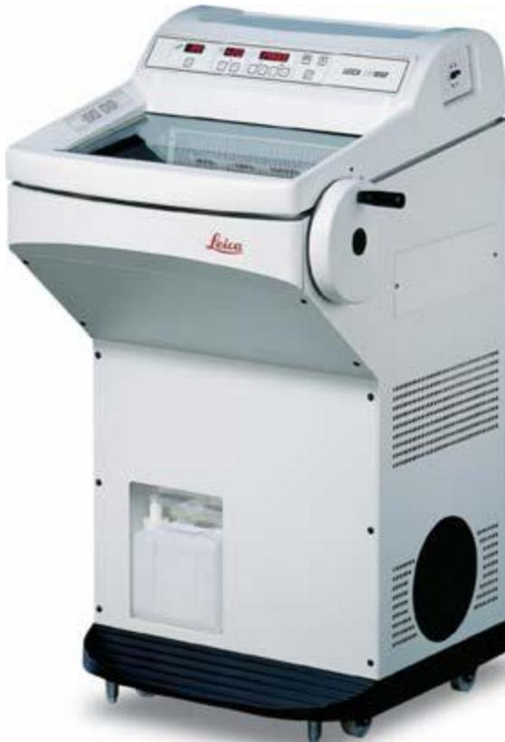
Equipo de criocorte para la obtención de cortes en congelación de muestras congeladas previamente por medio de micrótomo de rotación.
