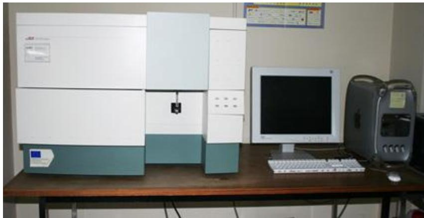
**FACScalibur** es un citómetro de flujo analógico de sobremesa que puede medir simultáneamente Forward Scatter (dispersión frontal), Side Scatter (dispersión lateral) y 4 fluorescencias.
