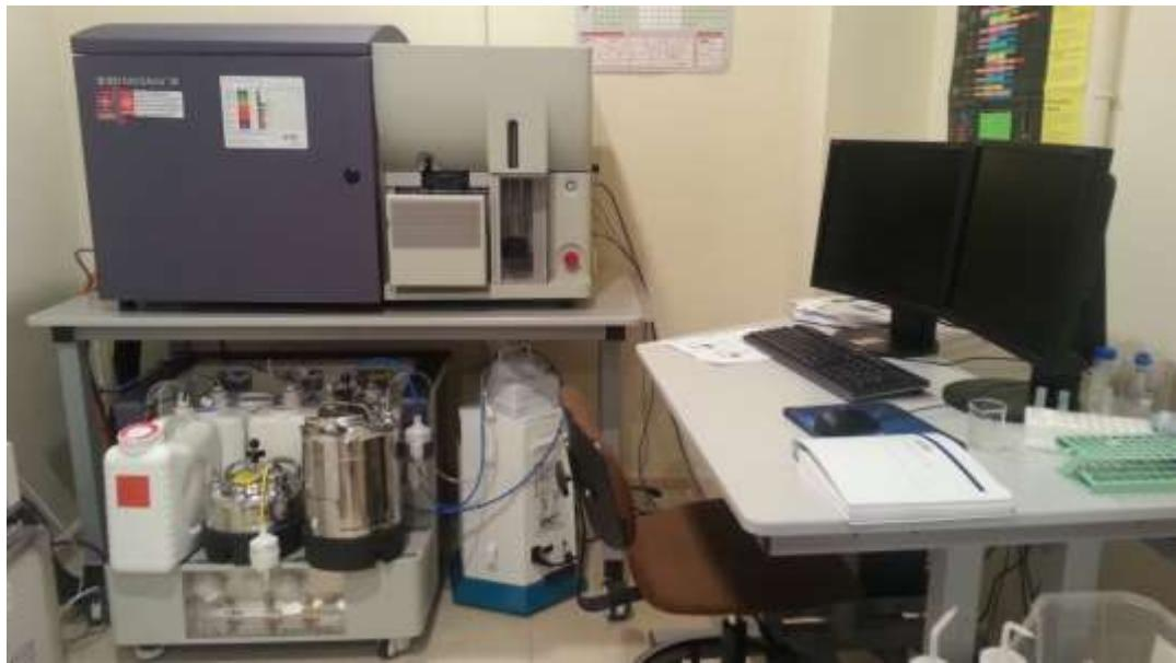
FACSAria III es un citómetro analizador separador de suspensiones celulares de alta velocidad y resolución, capaz de analizar hasta 13 parámetros a la vez, 11 de ellos de fluorescencia (5B+·3R+·3V).
