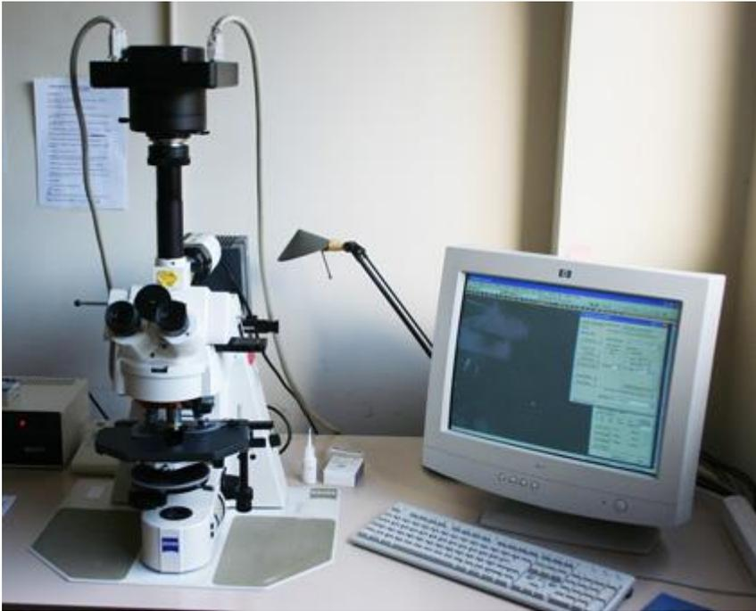
El microscopio vertical Zeiss Axioplan-2 se utiliza especialmente para el estudio y obtención de imágenes de muestras montadas sobre portaobjetos. Al estar equipado con sistemas de epiiluminación y transiluminación se pueden observar muestras procesadas con técnicas en fluorescencia, campo claro y combinación de ambas.
